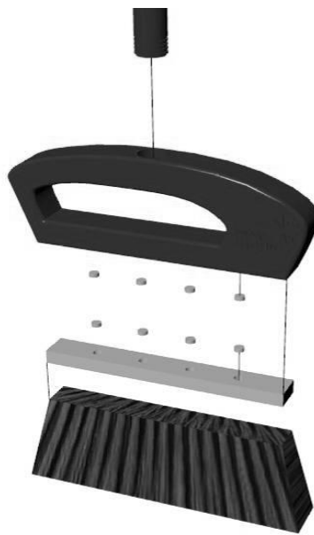
Figura 17 – Perspectiva explodida com sistemas de encaixe. Fonte: autores.
