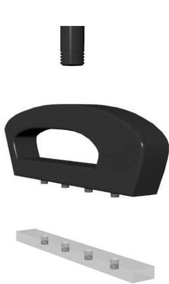
Figura 16 – Perspectiva explodida com sistemas de encaixe. Fonte: autores.
